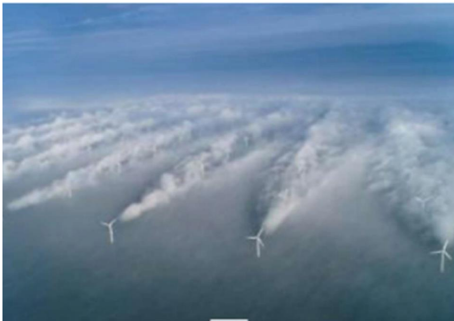
Bild 8: Hauptabstrahlrichtung des Infraschalls, Anzeige durch Kondensationswolken
