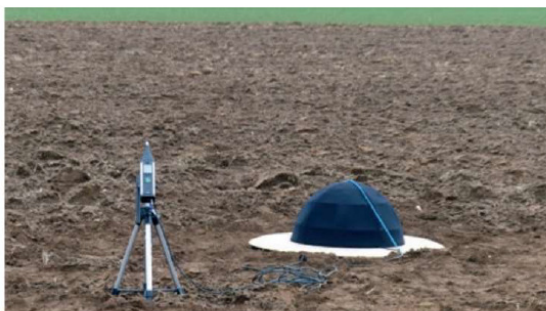
Abbildung 4.5-3: Schallharte Platte mit darauf montiertem Mikrophon und doppeltem Windschirm. Das eingesetzte Messgerät Typ DUO steht auf einem Stativ montiert daneben und ist über ein Messkabel mit dem Mikrophon verbunden. Foto: LUBW
